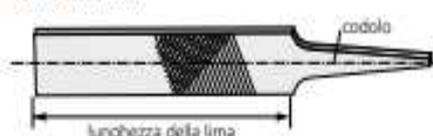
Le dimensioni della sezione riportate in tabella sono determinate in base al taglio e quindi possono variare con esso. Sulle lime rastremate il taglio viene misurato nel punto più alto e più largo.
