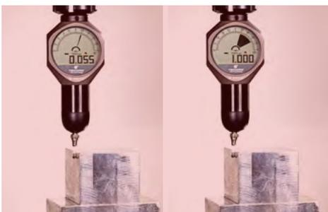
**Pericolo di incidente(0 mm fino a ERRO1)** In caso di sorpasso, il LED avvisa in rosso e la barra nera si accumula in senso orario verso destra. Poco prima dell'incidente (>1 mm), è possibile visualizzare ERRO1 sul display.
