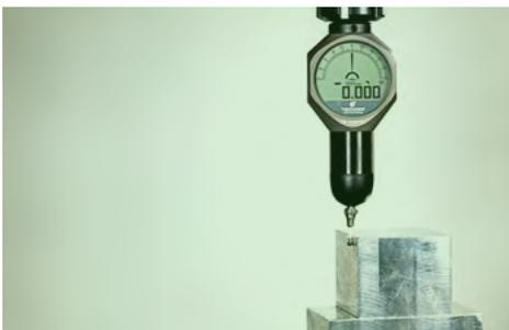
**Punto zero (precisamente raggiunto)** Quando viene raggiunto lo "0", l'asse del mandrino è posizionato esattamente sul bordo del pezzo.
