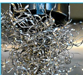
Lavorazione eseguita con maschio tradizionale, per applicazioni generiche, su acciaio inox. L'intasamento da trucioli impone dei fermi macchina e relativo intervento dell'operatore.
