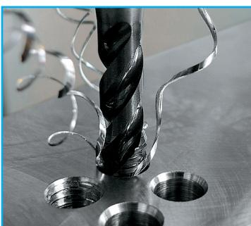
Lavorazione eseguita con maschio anello blu della serie V82 da M8 specifico per inox. Completamente esente la formazione di matassa ed intasamento da trucioli.
