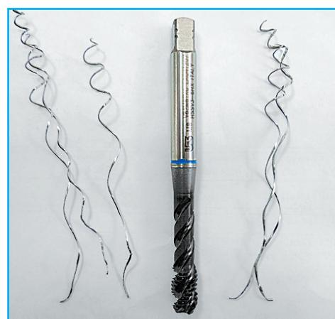
Il maschio della serie V82 e V83 produce trucioli regolari, minori interruzioni nel processo di produzione.
